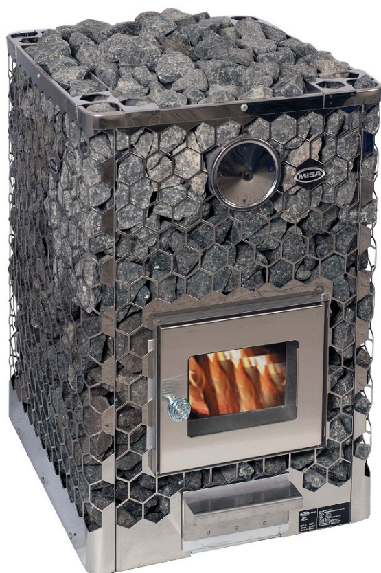
Kiviset med det yttre stenmagasinet fyllt med granit och det inre med keramisk bastusten, ett tunnt lager granit läggs sen överst.
